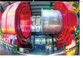
Die verschiedenen Lagen eines Detektors messen unterschiedliche Eigenschaften der neu erzeugten Teilchen. Spurdetektoren machen die Flugbahnen der am Kollisionspunkt erzeugten Teilchen sichtbar. Andere Lagen, die sogenannten Kalorimeter, messen die Energie der Teilchen. Der Detektor enthält auch einen Magneten, dessen Feld elektrisch geladene Teilchen ablenkt und damit bei der Identifizierung der Teilchen hilft.
